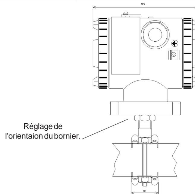
Pour régler l'orientation du boîtier il suffit de desserrer l'écrou de réglage, d'ajuster l'orientation et de resserrer l'écrou.
