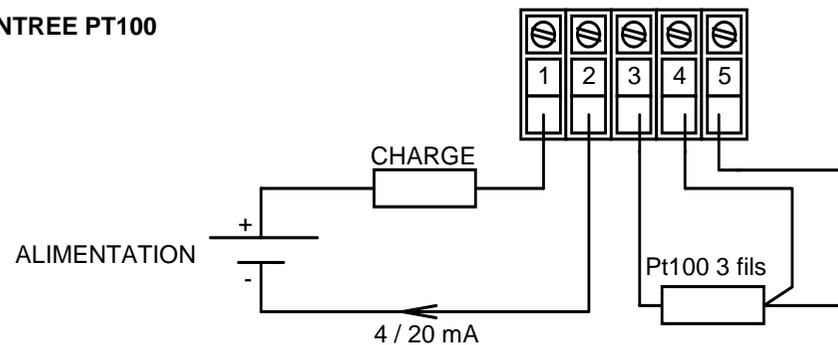
Pour une entrée PT100 2 fils, ponter les bornes 4 - 5
